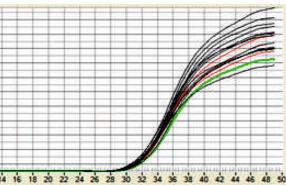
Кривые прироста флуоресценции внутреннего контрольного образца (ВКО) в пробах с различными вирусными нагрузками
